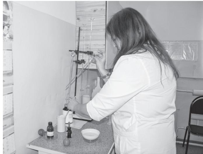
Тем не менее лаборатория на насосной станции продолжает работать, лаборант один раз в день проверяет качественные показатели воды вручную. Автоматическая система выдает эти данные регулярно - с разницей в несколько секунд. Для большей надежности они сравниваются.
